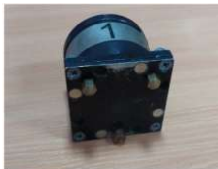
Фото 2.3. Датчик с закрепленными коническими ножками для установки на любую поверхность
