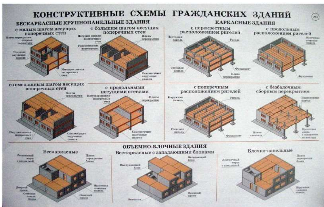
Рисунок 2.3. - Конструктивные схемы гражданских зданий.
