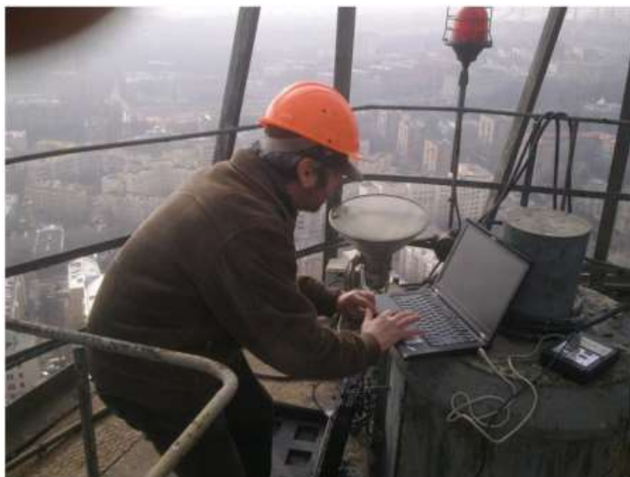
Рис. 2.2. Пример оборудования пункта сбора динамических данных на верхней площадке стальной башни
