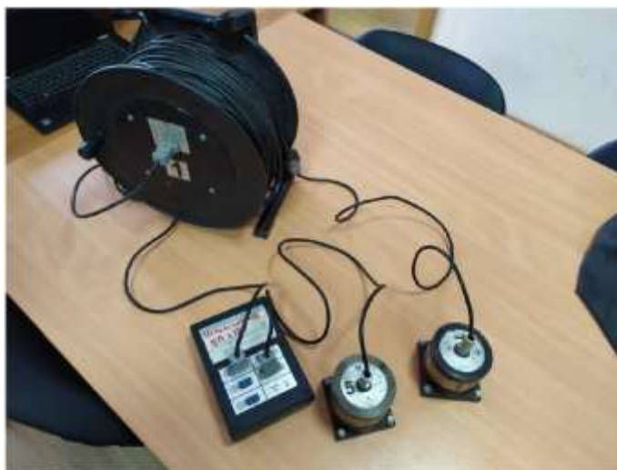
Фото 2.4. Пример соединения датчиков через катушку и короткий кабель с АЦП
