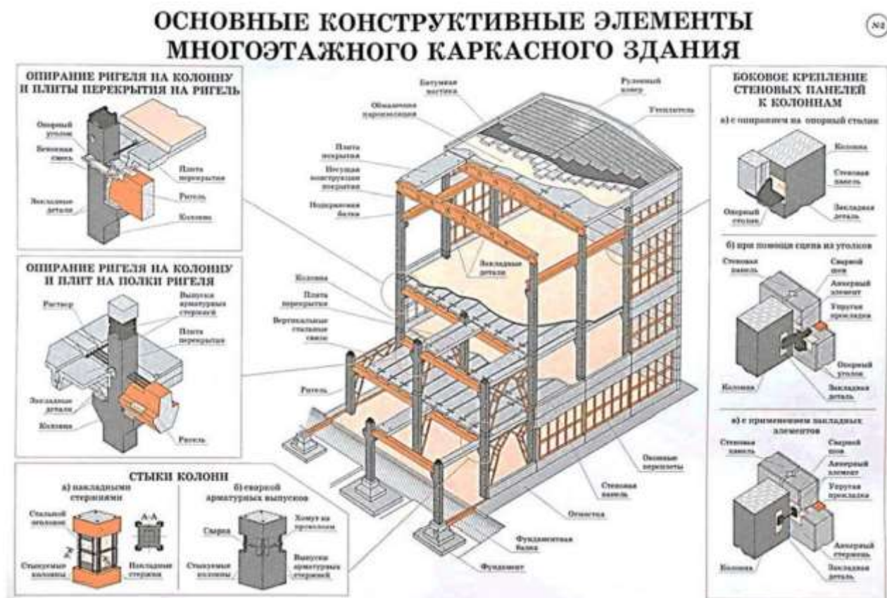
Рисунок 2.5. Основные конструктивные элементы многоэтажного промышленного здания
