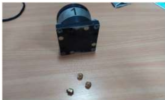
Фото 2.2. Датчик с незакрепленными коническими ножками для установки на стальную поверхность
